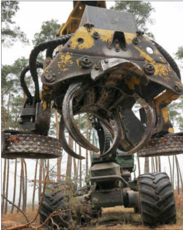
Das sogenannte Aggregat, der Harvesterkopf, mit Säge, Greifarm und Entaster.
