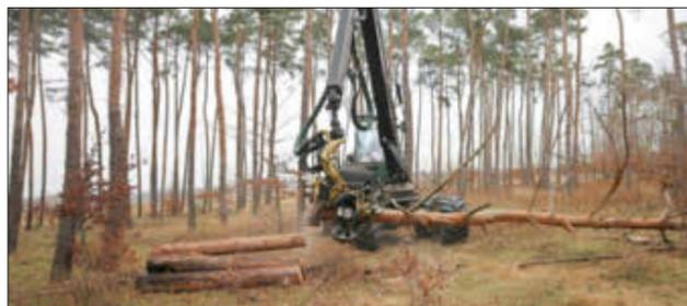
Und die Zeit läuft: Keine zwei Minuten dauert es, bis der Harvester die Kiefer gefällt, entastet und in maßgenaues Palettenholz geschnitten und aufgereiht hat.
